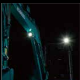
LED前方作業灯 画像はキャブ仕様。キャノピ ライトはオプションです。
