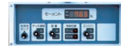
デッキ操作部
