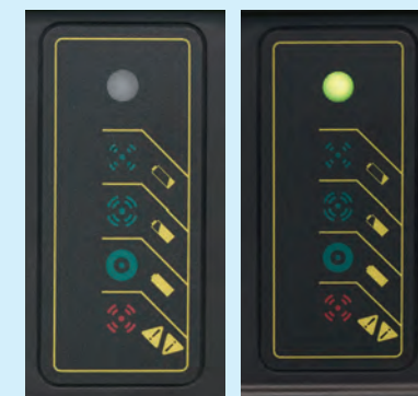
》充電状態表示灯 表示灯の色および点灯・点滅で、充電器の状態を表示。
